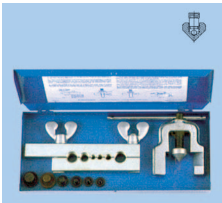
Рис. 12.4.10. Вальцовки: а – с конусным пуансоном; б – с фигурным пуансоном
