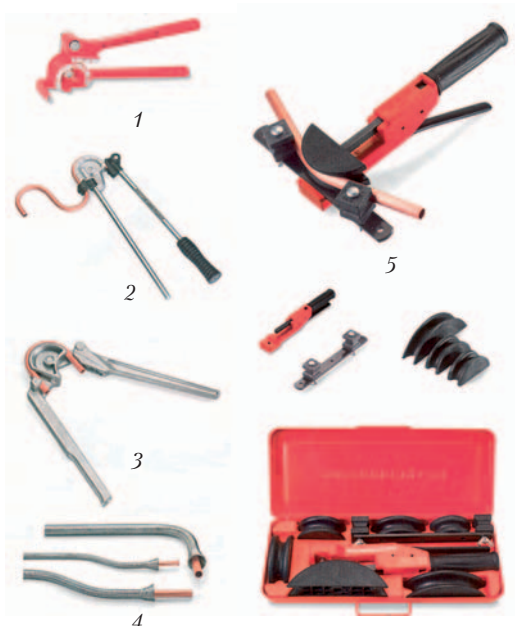
Рис. 12.4.7. Трубогибы ручные: 1, 2, 3 – рычажные, 4 – пружинный; 5 – гидравлический
