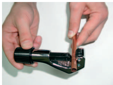
Рис. 12.4.3. Резка медной трубы труборезом
