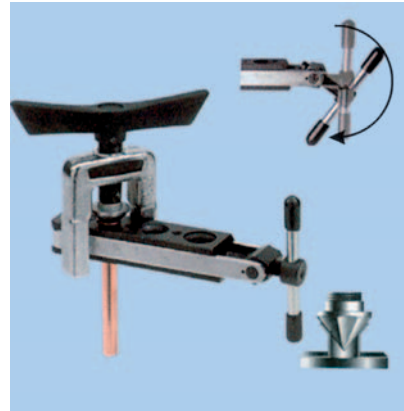
Рис. 12.4.10. Вальцовки: а – с конусным пуансоном; б – с фигурным пуансоном
